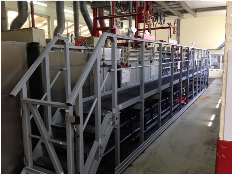
Abb. 1: Anlage zum Elektropolieren mit Absturzsicherung am Bediengang
