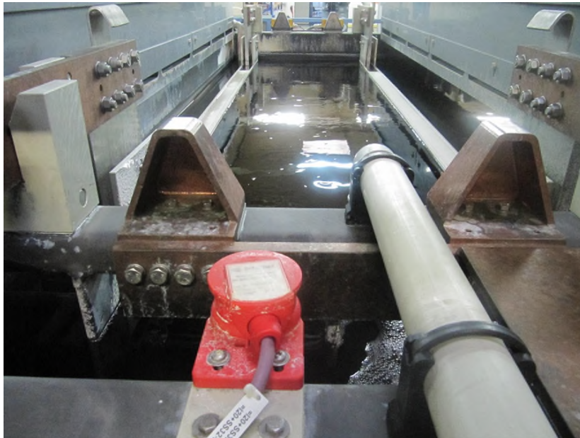
Abb. 3: Elektrolytische Entfettung mit beidseitiger Randabsaugung
