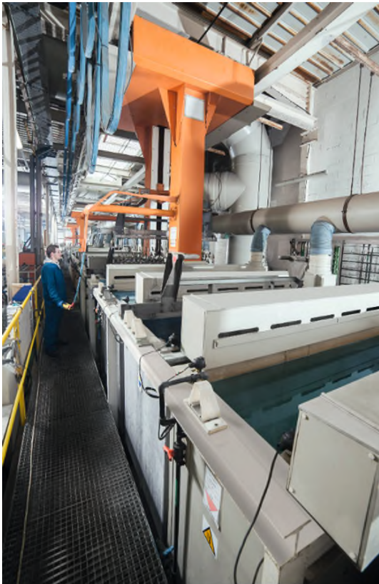
Abb. 4: Dekapierung an einer halbautomatischen Gestellanlage
