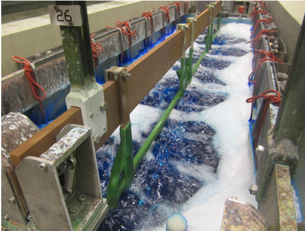
Abb. 11: Luftbewegter Elektrolyt zum sauren Verkupfern
