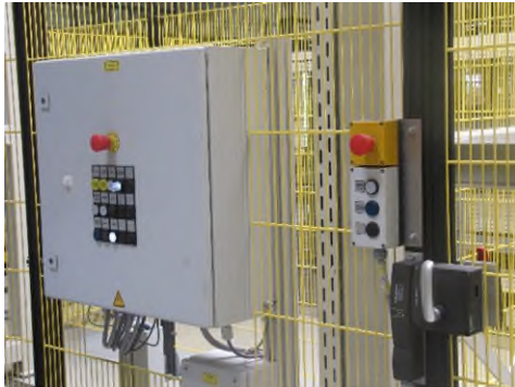
Abb. 21: Beseitigung von Störungen nur bei stillgesetzter Anlage – verriegelte Tür schützt vor ungesichertem Zugang
