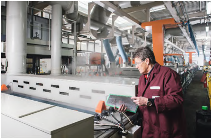
Abb. 23 Prüfung der Galvanikanlage durch eine befähigte Person
