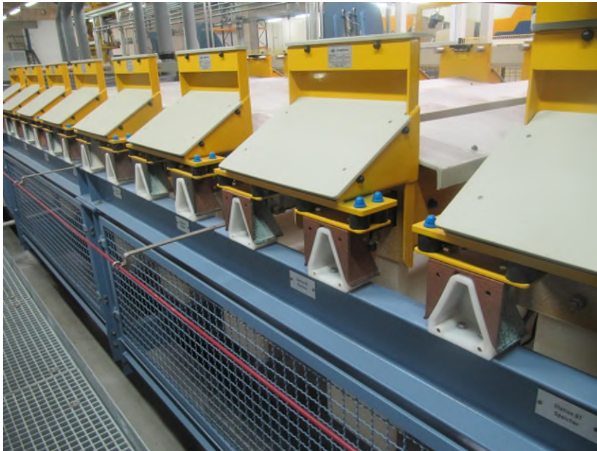
Abb. 14: Trommelanlage zum alkalischen Verzinnen mit Reißleine als Not-Halt-Einrichtung
