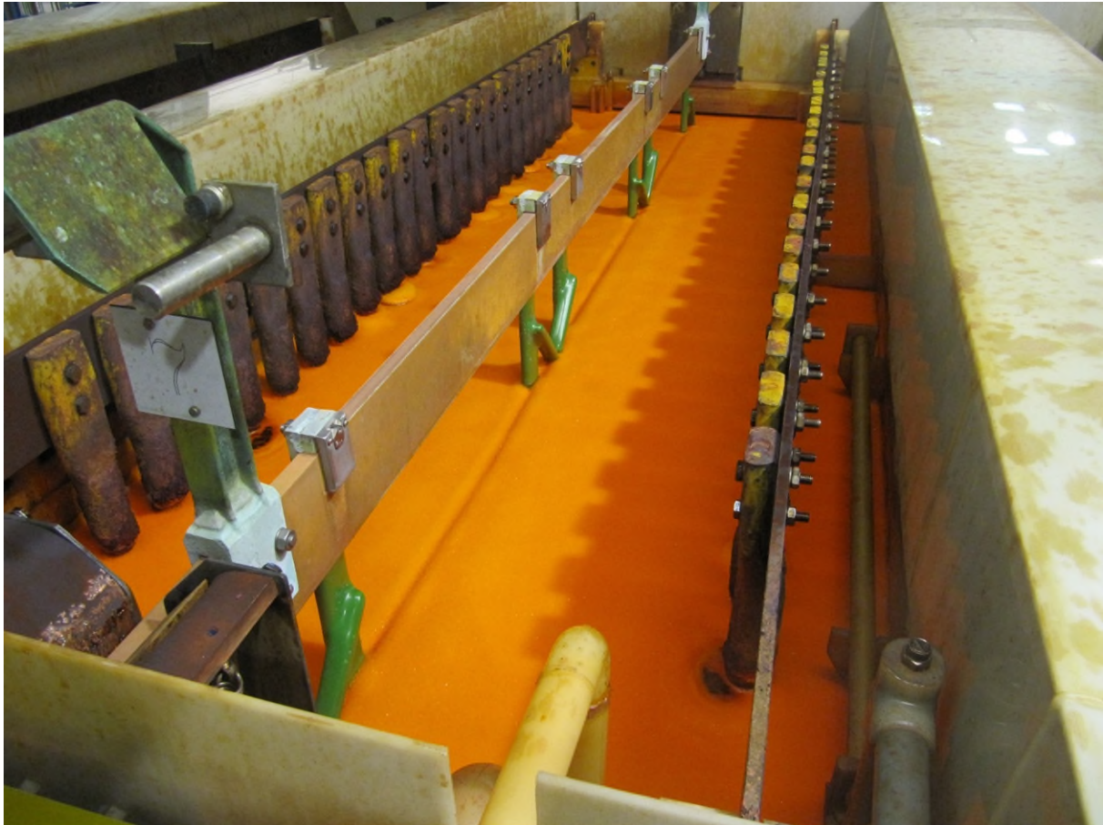
Abb. 7: Hartverchromen mit Netzmittel auf dem Elektrolyten
