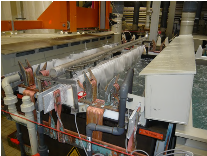
Abb. 16: Eloxieren mit Kathodenumhüllung und Push-Pull-System zur Erfassung der Schwefelsäure-Aerosole
