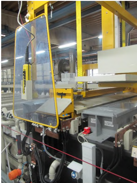
Abb. 8: Anlage zum Glanzverchromen mit Anfahrbügel am Transportwagen und Tropfschale
