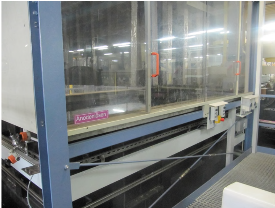
Abb. 18: Eingehauste Anlage zum Entmetallisieren
