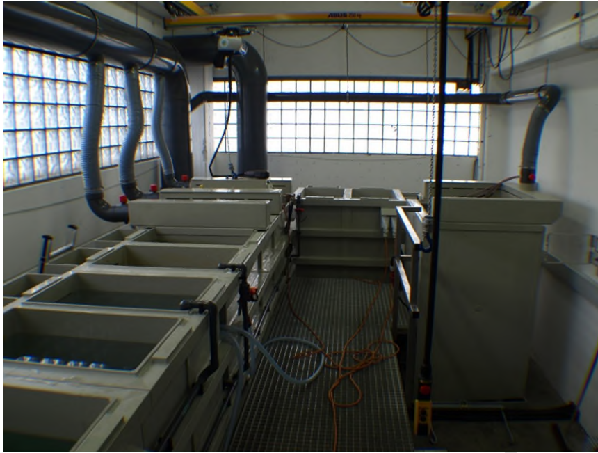
Abb. 10 Handbeschickte Anlage zum chemischen Vernickeln – Stolpergefahr durch Schläuche vermeiden
