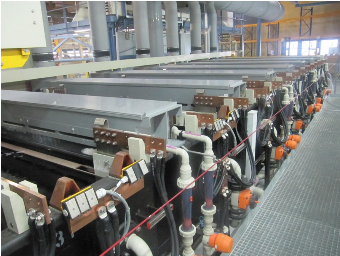
Abb. 6: Hartverchromen von Serienbauteilen in Gestellanlage mit Beschickungseinrichtung
