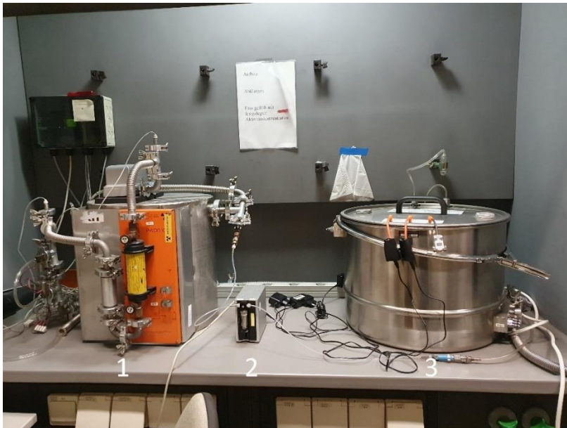
Abbildung 25: Karlsruher Expositionsanlage mit Pufferbehälter [1], Pumpe [2] und dem Expositionsfass [3]
