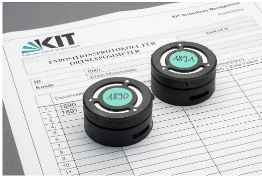
Abbildung 1 Karlsruhe Radonexposimeter mit Expositionsprotokoll
