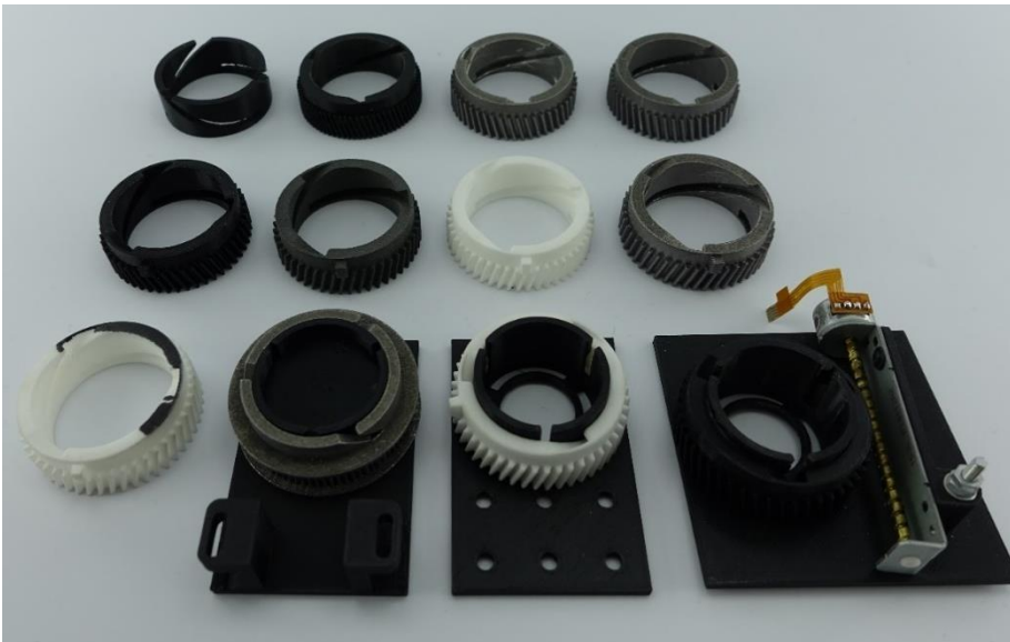
Abbildung 14: Kulissen im Test zur Verfassung des Stempels (Ventils)
