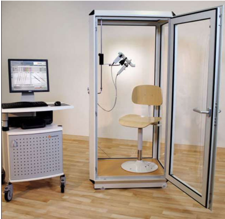
Abb. 1: Bodyplethysmograph: MasterScreen Body (Jaeger®) mit Arbeitsplatz und Software SentrySuite (Quelle: Carefusion)
