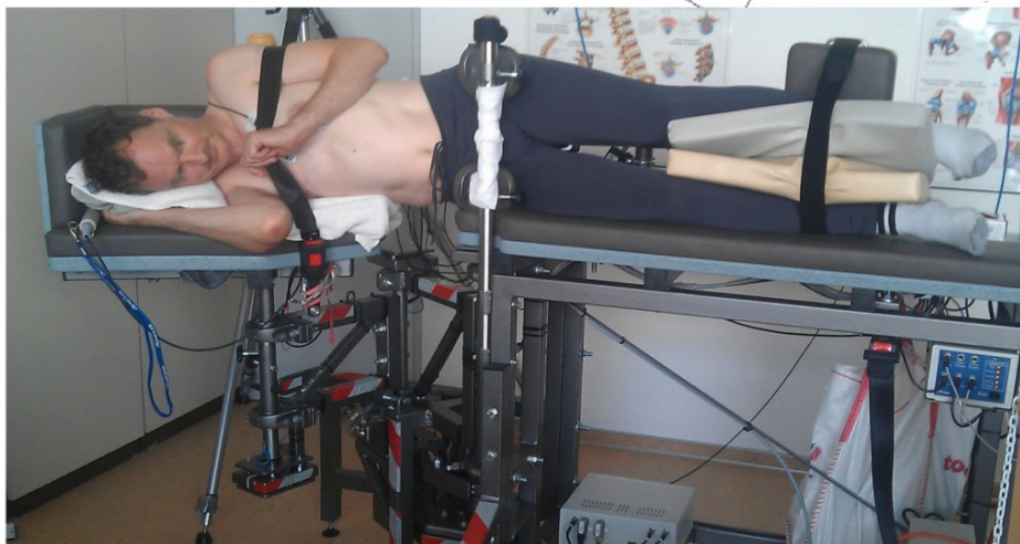
Abbildung 1: Prinzipieller Aufbau der Rumpfbeugemaschine (RUBEMA). A: Der Unterkörper liegt mit Beinen und Becken auf einem fixen Tisch, wobei Becken an drei Punkten und die Beine an den Unterschenkeln fixiert sind. Die Knie wurden während der Tests mit Kissen entlastet. Der Oberkörper lagert auf einem mobilen Tisch und ist mit einem Gurt über Schultern und Thorax gesichert. Angetrieben wird der mobile Tisch über Achsen A und B, welche durch Drehmotoren Momente erzeugen können. Die dritte Achse S ist reibungsfrei nicht motorgetrieben und dient einzig der Lageanpassung des Oberkörpers und der Positionierung des Punktes K. K wirkt über eine gepolsterte Rolle hinter dem Oberkörper auf Oberkante der Schulterblätter als Kräfteinleitungspunkt. Haupt-Moment beim Beugen einer Versuchsperson wird von Motor um Achse A aufgebaut, wogegen Motor B dazu dient, Längen zwischen verschiedenen Personen und während einer Beugung anzupassen. B: Ein Proband in der RUBEMA. Gut sichtbar sind die Fixierungen und die Knieentlastung. Die Polster vor dem Becken sind die Haupt-Auflage-Flächen, um welche die Probanden während der Test gebeugt wurden.
