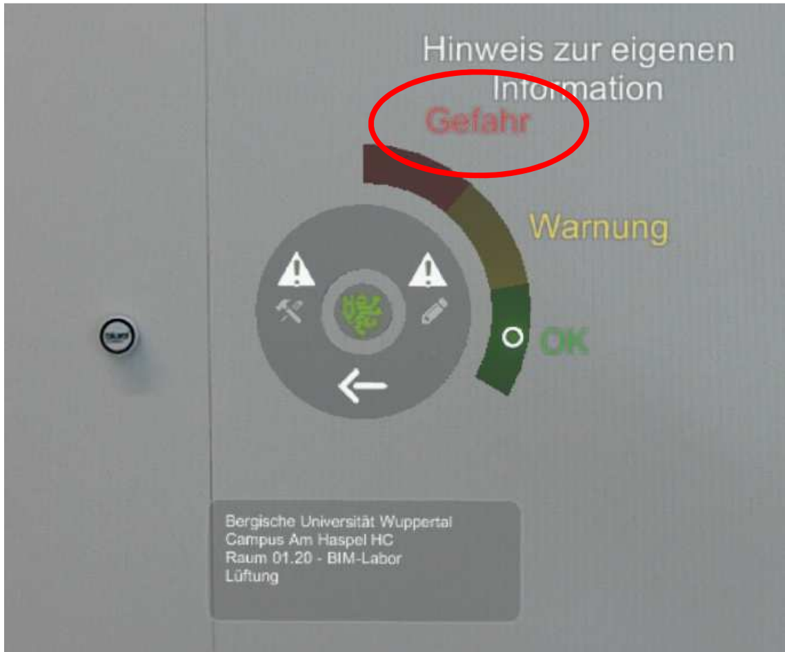
Abbildung 47: Gefahrenmeldung über Bluetooth-Beacon
