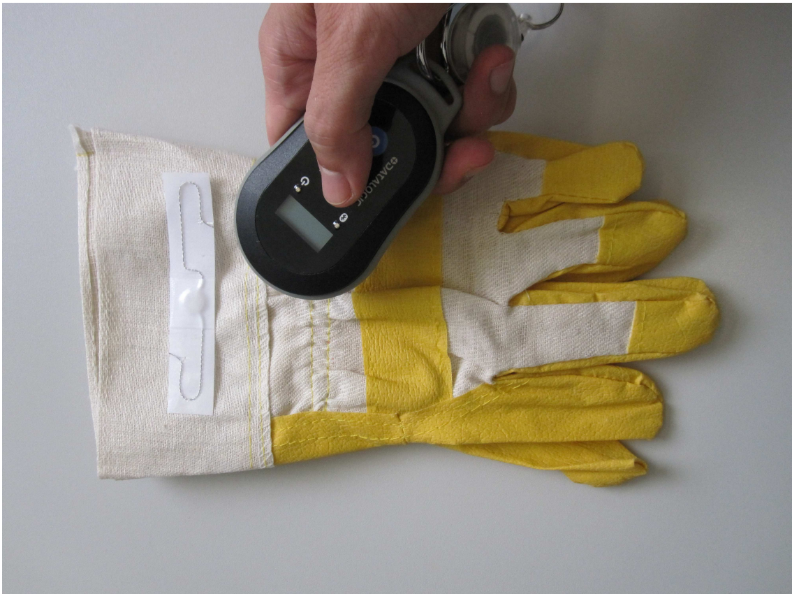
Abbildung 45: Informationsverarbeitung mit RFID (3)
