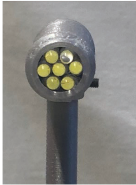
Abbildung 6.2.2-4: Blendlichtquelle mit 7 LEDs
