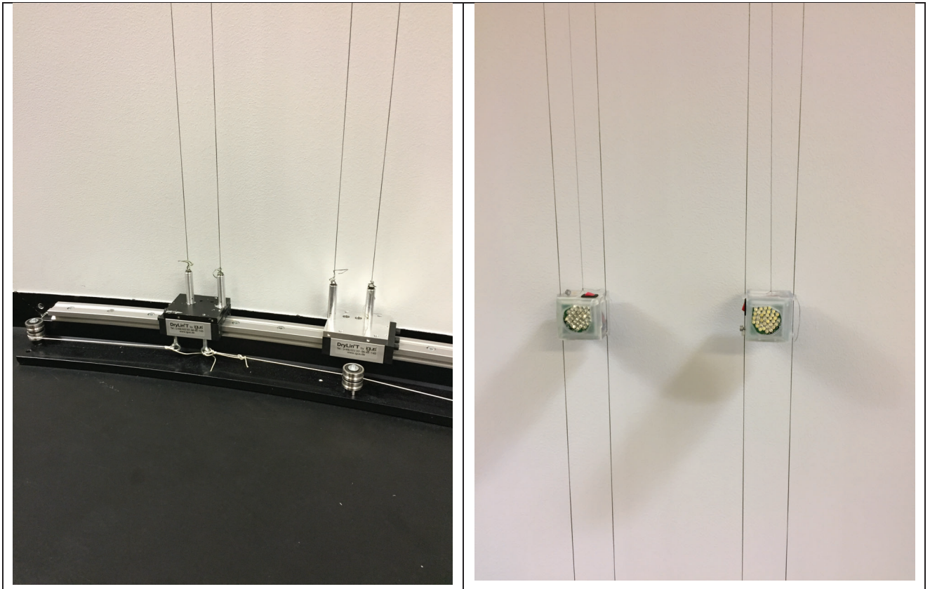
Abbildung 4.2-8: links: Aufhängung der Führungsseile der Blindlichtquelle (BLQ) an der Laufschiene; rechts: BLQ mit Führungsdrähten (links und rechts) und dem dünnen Faden für die Vertikalbewegung (in der Mitte zwischen den beiden Führungsdrähten)
