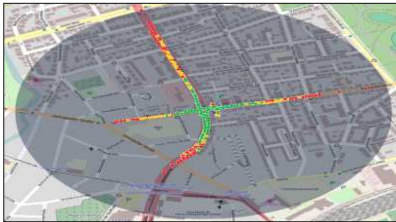
Abbildung 3-4. Empfangsmessung an einer innerstädtischen Kreuzung (Braunschweig) Farbkodierung in Tabelle
