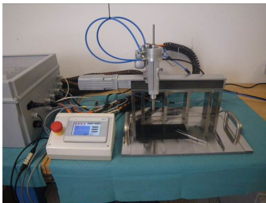
Abbildung 2: Versuchsaufbau Stanzvorrichtung mit separatem Steuerungskasten und Bedienpanel zur Anwahl der programmierten Versuchsmuster
