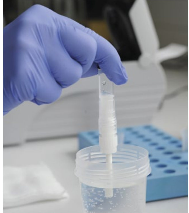
Abb. 1: Der Messstift wird direkt in das zu untersuchende Wasser getaucht und das Messergebnis liegt innerhalb von fünf Minuten vor.
