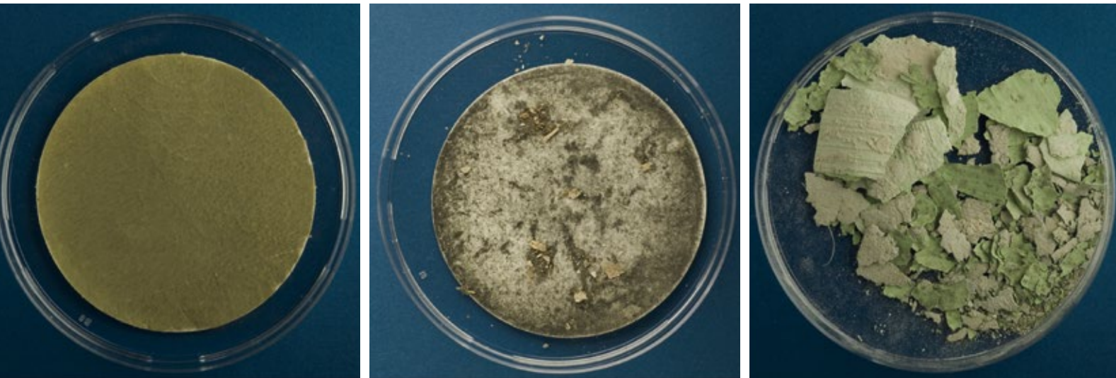
Schimmelpilze in Staubproben (abgesaugte Wände) und Wandmaterial (Tapeten, Putz, Farbreste)
