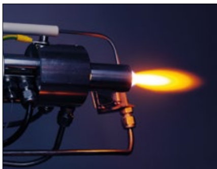
Das IPA hat ein Komplettsystem für eine qualitätsgesicherte Expositionsgenerierung von Nanopartikelatmosphären entwickelt. Dieses wird im Expositionslabor eingesetzt. ▶ Seite 17
