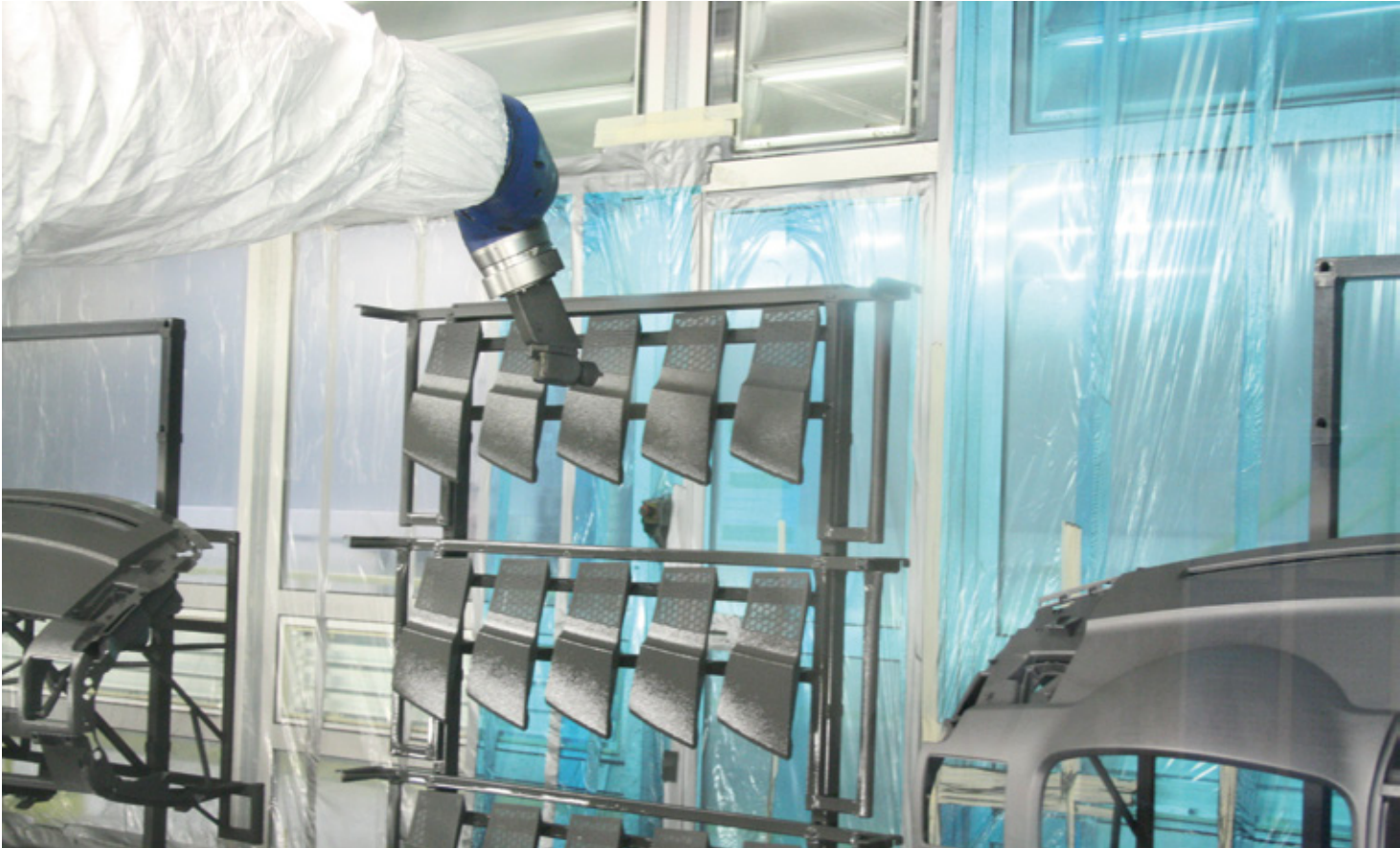
Lackierung von Kunststoffteilen in der Automobilindustrie.
