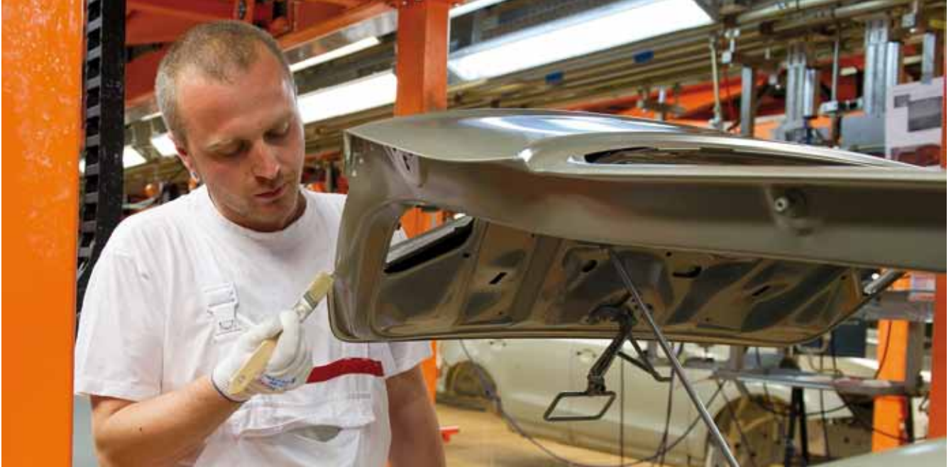
Die Mitarbeiter tragen mit einer Spritzpistole Plastisol auf die Schweißnähte auf und verstreichen die Masse anschließend mit dem Pinsel.
