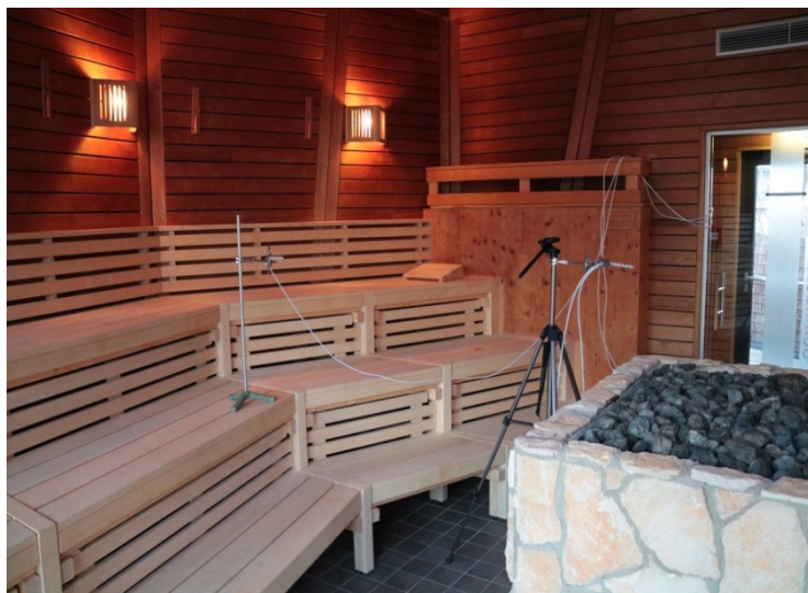
Probenahmestellen im Saunaraum Aufgießer und Bank
