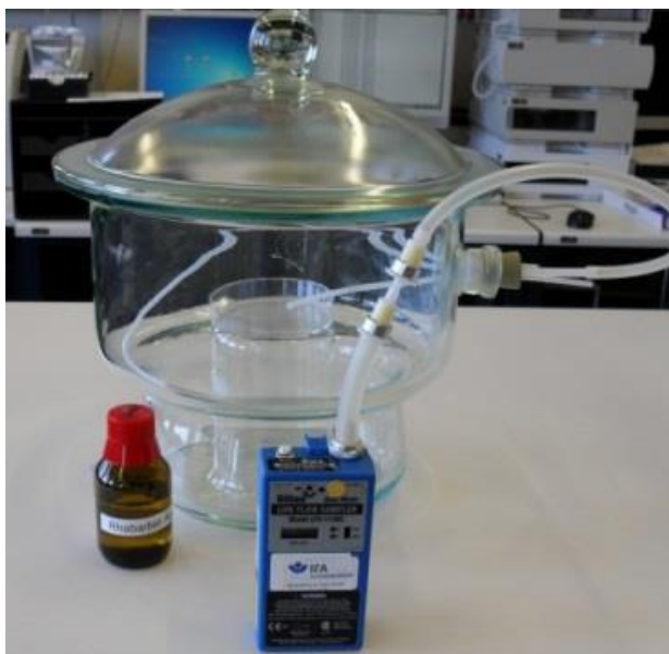
Bild 1: Versuchsaufbau Emissionsmessungen bei Raumtemperatur
