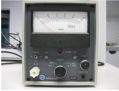
Bild 3: Direktanzeigendes Formaldehydmessgerät Interscan 1166
