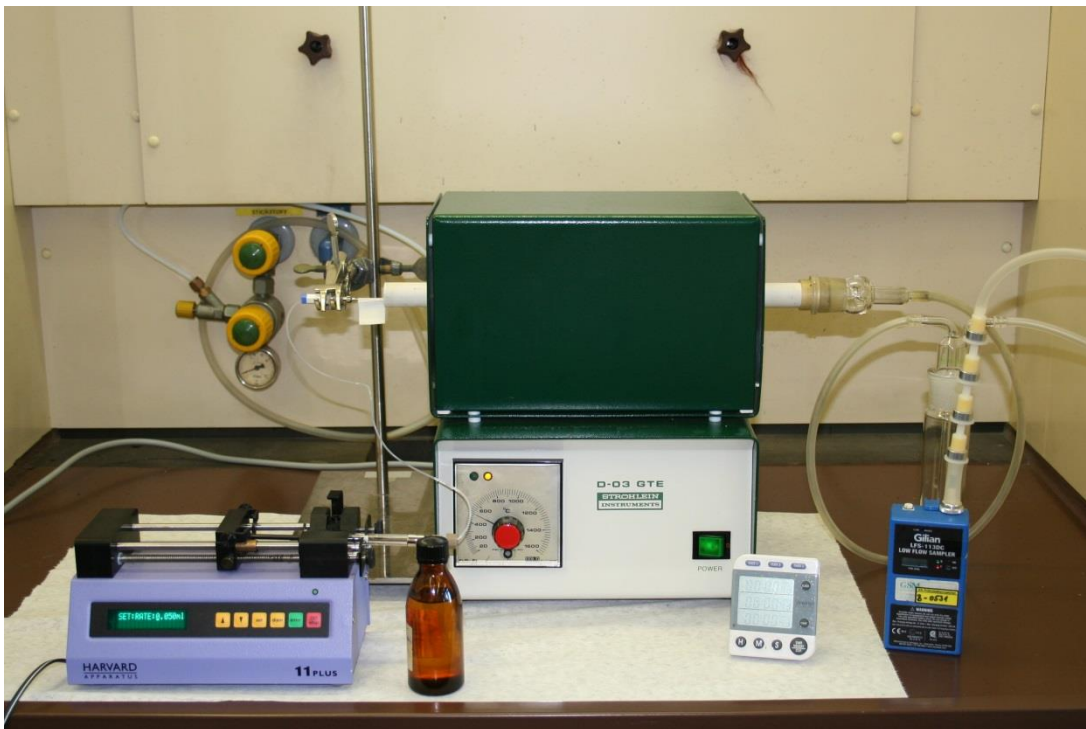
Bild 2: Versuchsaufbau Emissionsmessungen bei höheren Temperaturen
