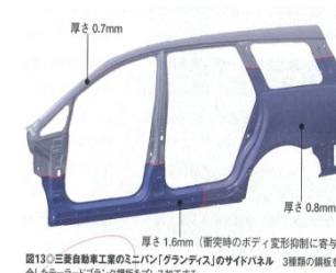
図13 三菱自動車工業のミニバン「グランディス」のサイドパネル。3種類の鋼板を接合したチアードプラック鋼板をプレス加工する。
