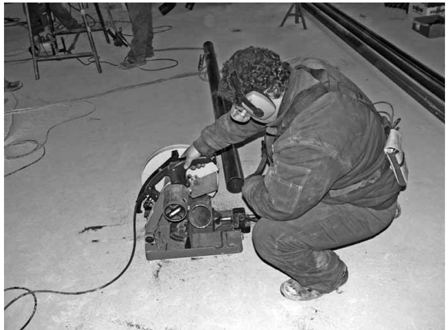
Abbildung A.29: Heizungsrohr mit Kappsäge kürzen
