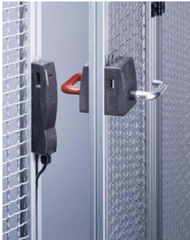
Abbildung 20: Sicherheitszuhaltung mit integrierter Stellungsabfrage und ergonomischer Handhabung
