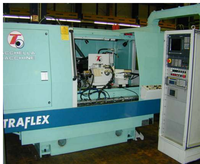
Abbildung 13: Blick in den Arbeitsraum der Schleifmaschine
