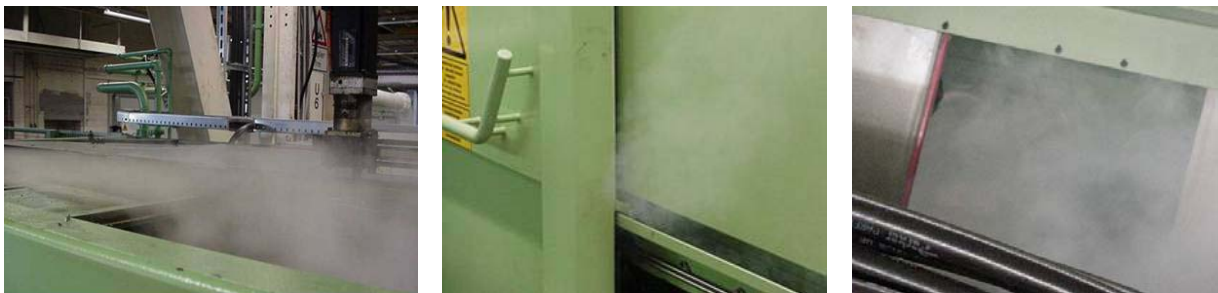
Abbildung 5: Beispiele für Undichtigkeiten am Maschinengehäuse
