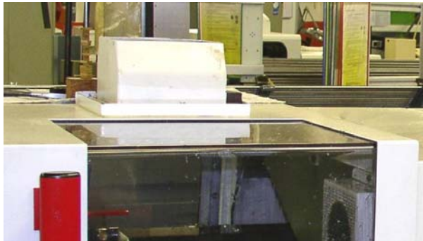
Abbildung 6: Beispiele einer Anordnung einer Druckentlastungseinrichtung
