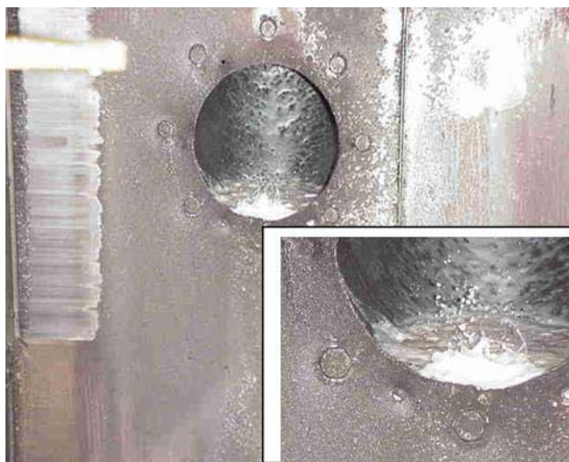
Abbildung 3: Beispiel für die Anreicherung von KSS-Emissionen an ungünstigen Absaugstellen
