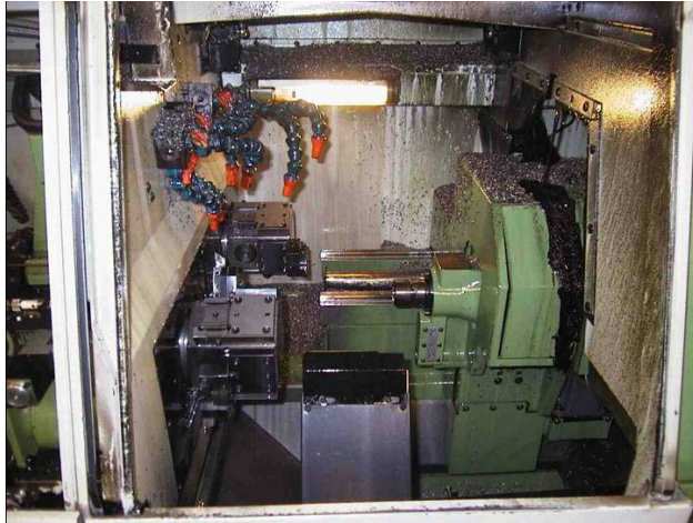
Abbildung 1: Brand an einer Drehmaschine aufgrund mangelnder KSS-Zufuhr
