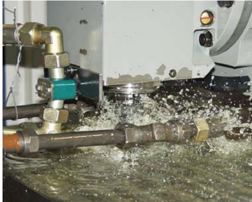
Abbildung 8: Blick in den Arbeitsraum beim Fräsen mit Öl als Kühlschmierstoff
