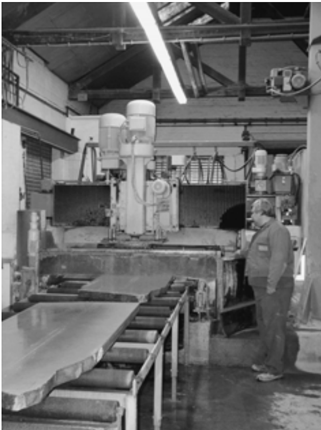
Abbildung 17: Maschinelles Nassschleifen von Naturwerksteinen
