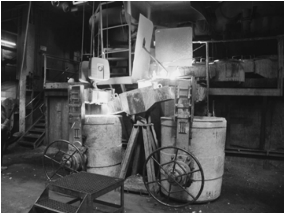
Abbildung 39: Flüssiges Metall wird in die Gießpfanne überführt
