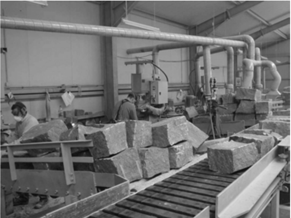
Abbildung 20: Maschinelles Spalten von Steinblöcken
