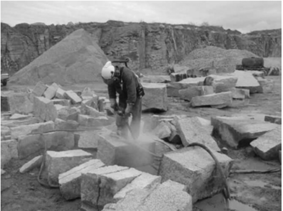
Abbildung 21: Spalten von Natursteinen mit einem Drucklufthammer
