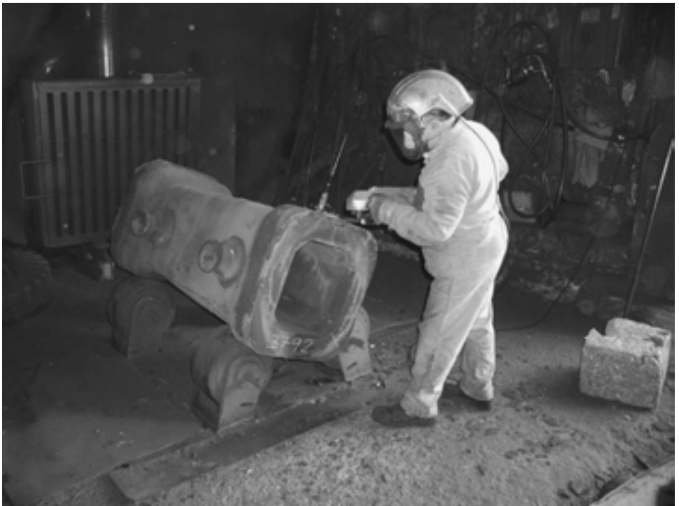
Abbildung 40: Das erkaltete Gusstück wird mit einem Winkelschleifer geputzt, z.B. um Lunkereinschlüsse zu entfernen
