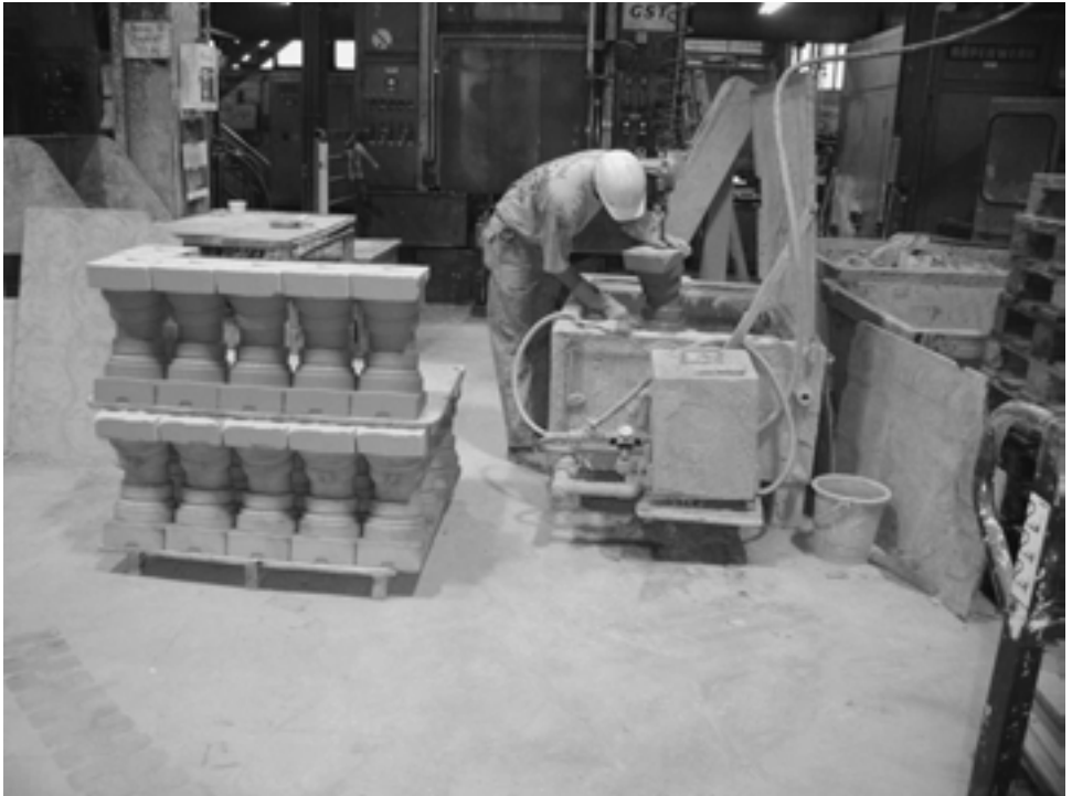
Abbildung 37: Tauchen der fertigen Kerne in Schlichtelösung
