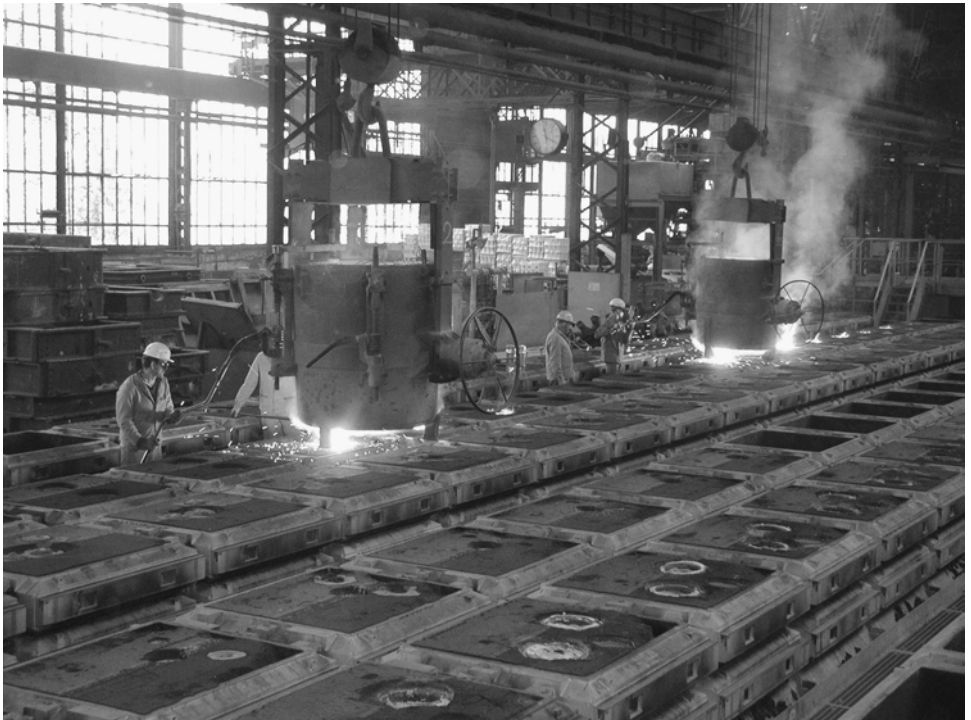
Abbildung 35: Abgießvorgang in einer Gießhalle
