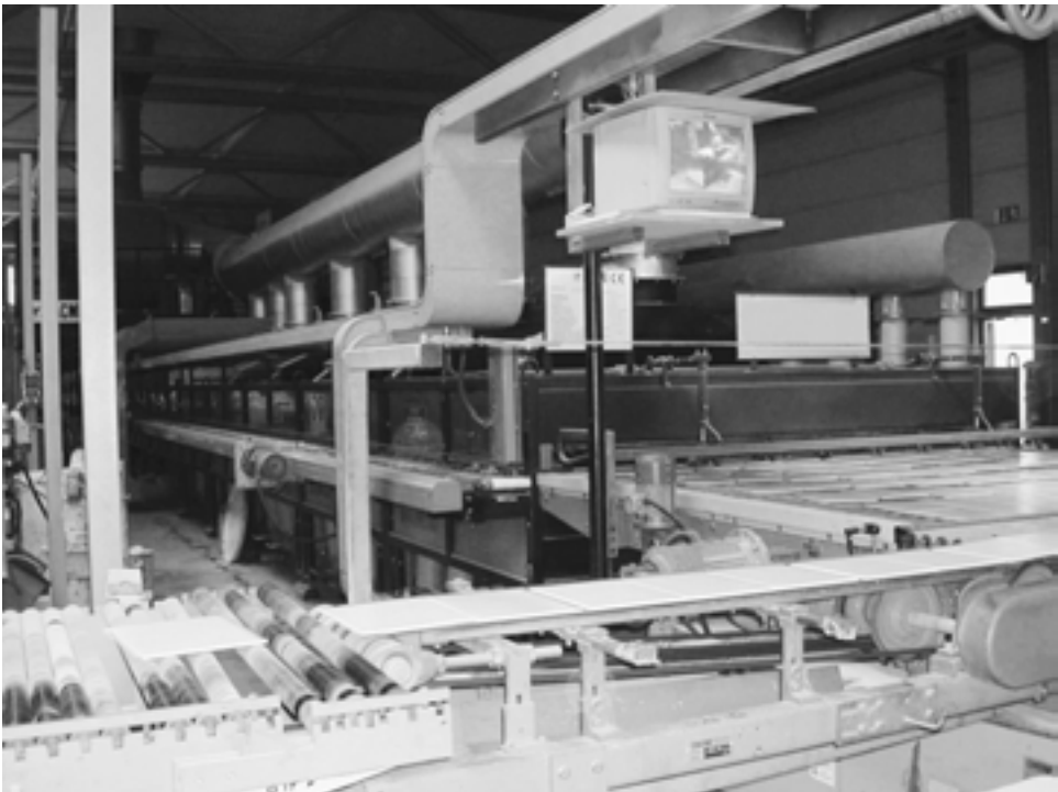
Abbildung 33: Fliesenproduktion im Schnellbrandofen
