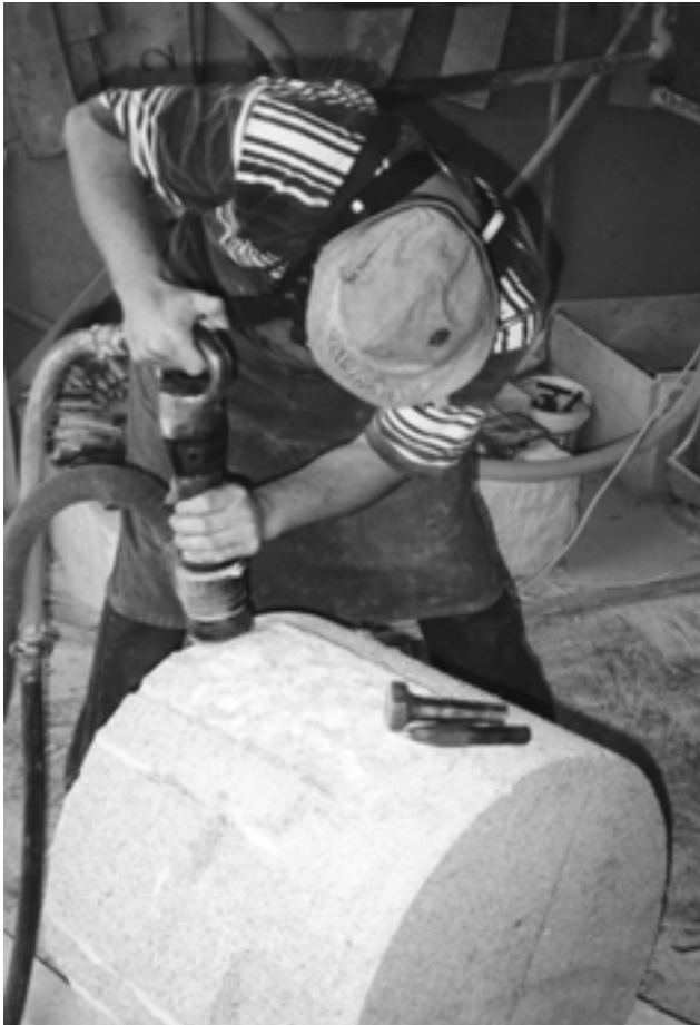
Abbildung 19: Manuelle Bearbeitung an Naturwerksteinen: Stocken
