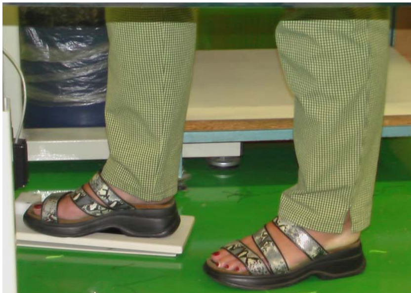
Abbildung 108: Neu entwickeltes frei positionierbares Fußpedal mit einer Bauhöhe von 25 mm, geeignet für sitzende und stehende Körperhaltung
