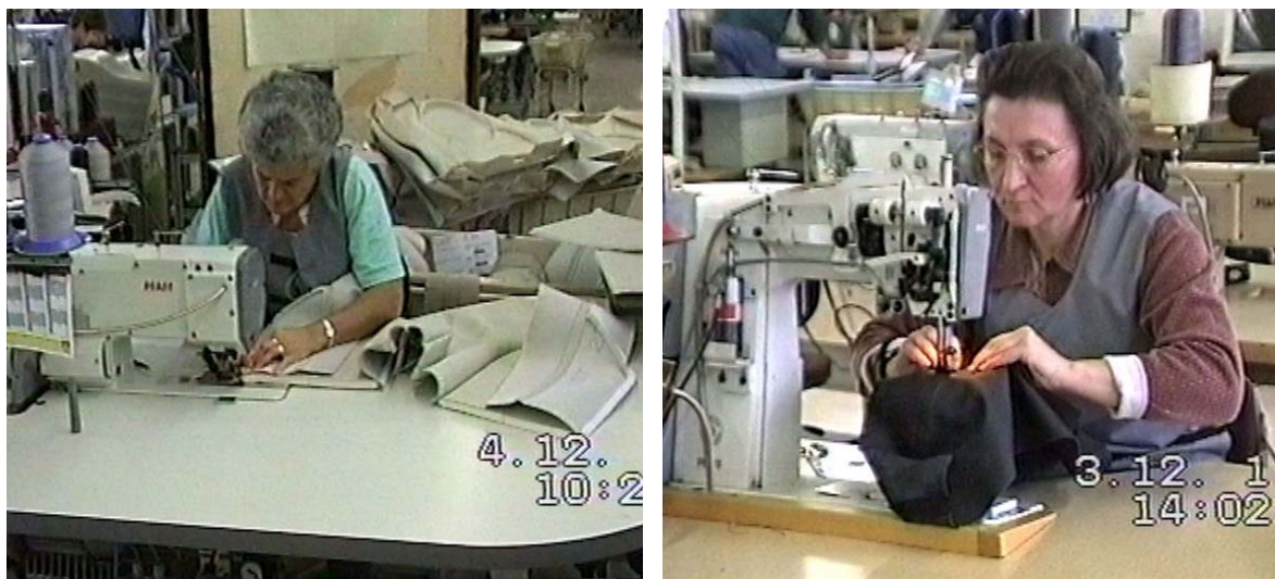
Abbildung 19: Nähen von Sitzbezügen (links) und Kopfstützen (rechts) bei der Fa. RECARO in sitzender Körperhaltung
