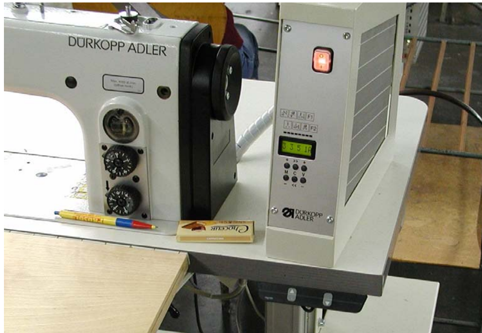
Abbildung 58: Ergonomisch optimierte Anordnung der Informationsaufnahme- und Bedienelemente
