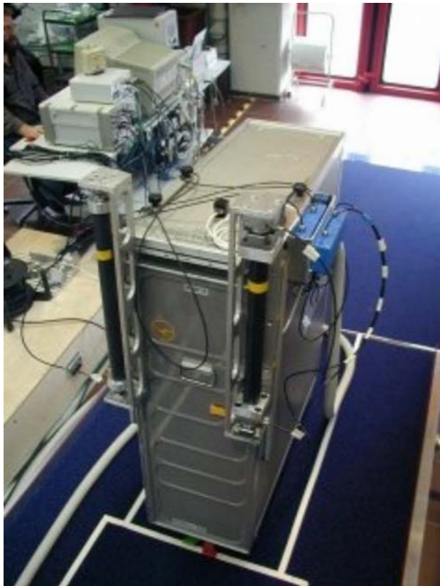
Abbildung 5-8: Adaptiertes Handkraftmesssystem mit Verkabelung und Messstation
