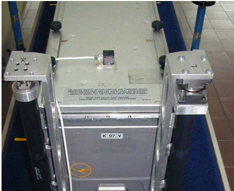
Abbildung 5-11: Adaptierter dreiaxialer Beschleunigungssensor am Fullsize-Trolley
