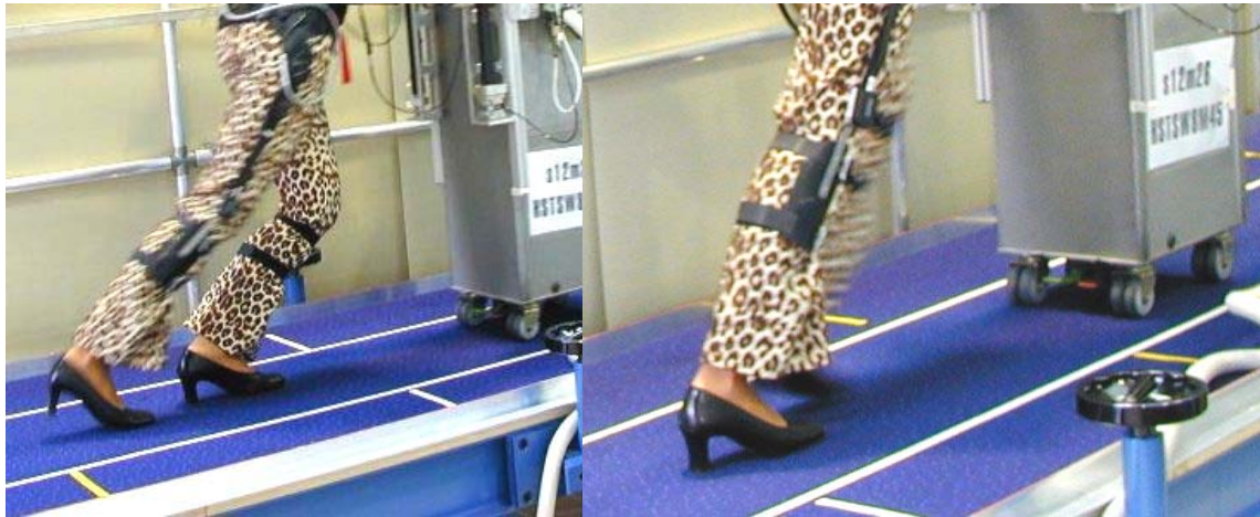
Abbildung 5-58: Fußhaltung beim Bergaufschieben mit erhöhten Schuhabsätzen
