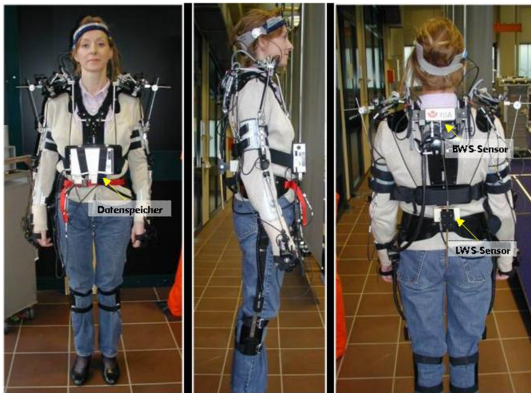
Abbildung 5-15: Versuchsperson mit angelegtem CUELA-Messsystem
