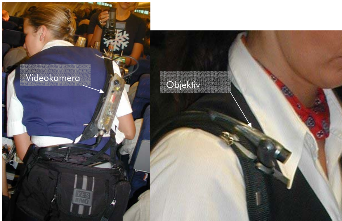
Abbildung 3-2: Personengebundene Videokamera mit Miniaturoptik
