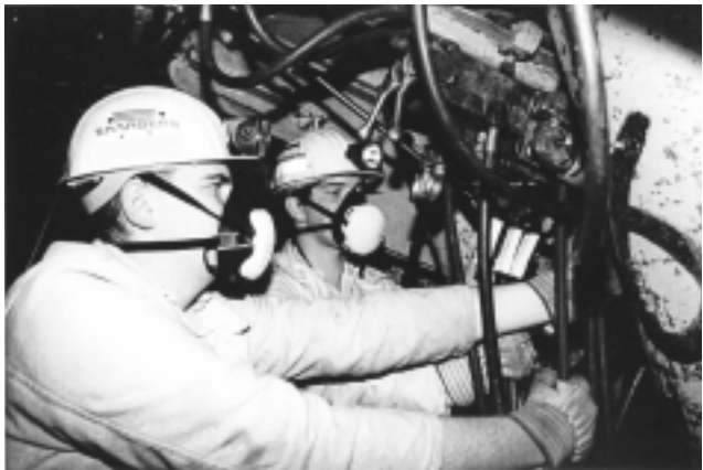
Abbildung 6: Filternde Staubschutzmaske vom Typ Picco 20 SA im untertägigen Einsatz
