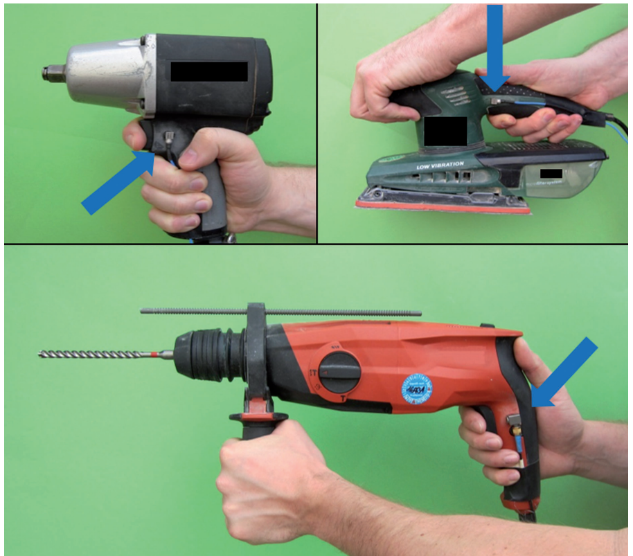
Bild 1 Normgerechte Anbringung der ICP Beschleunigungsaufnehmer an die Testmaschinen.
