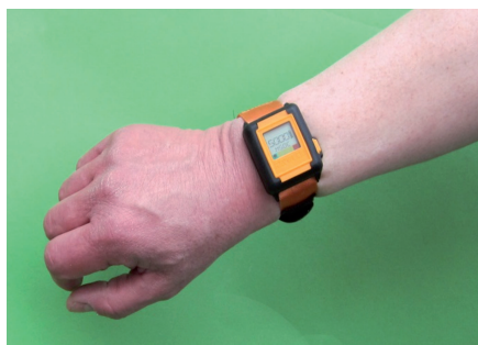
Bild 2 Befestigung des Dosimeters (HAVwear-System) an einer Probandenhand.
