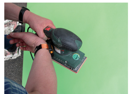
Bild 4 Anmelden der Maschine an das Dosimeter (HAVwear-Modul).
