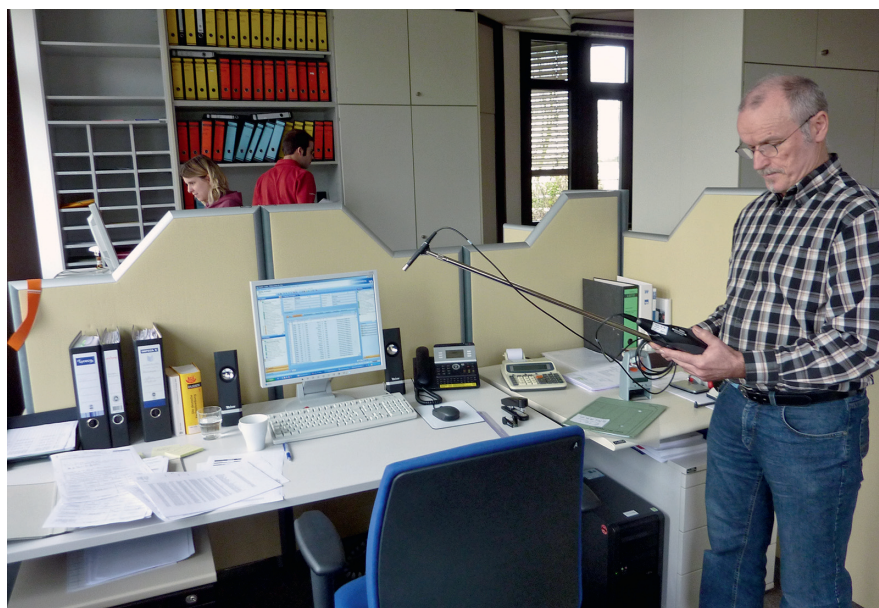
Abb. 3: Lärmmessung an einem Büroarbeitsplatz mit einem an einer Stativstange geführten Mikrofon.
