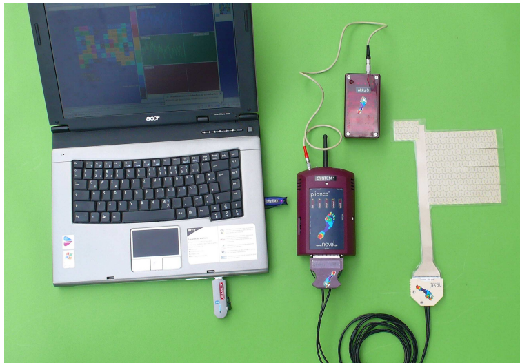
Bild 3: Sensormatte, Verstärkereinheit mit Akku-Stromversorgung
