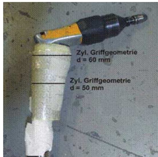
Bild 10: „Finger-Matrix“ am Drehschrauber mit Angaben zum Griffdurchmesser
