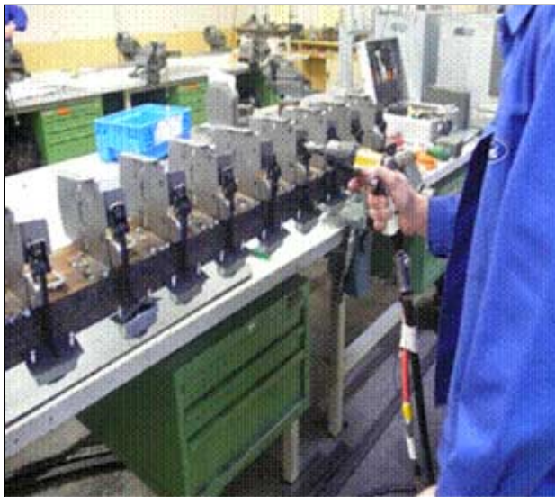
Bild 9: Simulierter Arbeitsablauf der Türmontage
