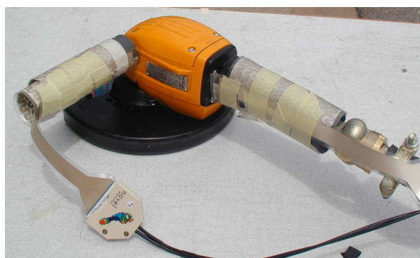
Bild 7: Winkelschleifer mit modifiziertem Griff und „Finger-Matrix“
