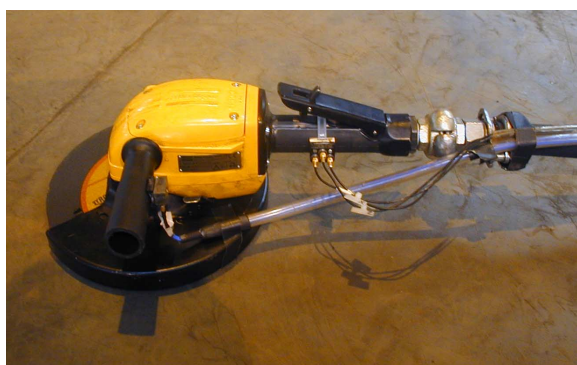
Bild 6: Winkelschleifer mit Beschleunigungsaufnehmer (vibrationsgemindert)
