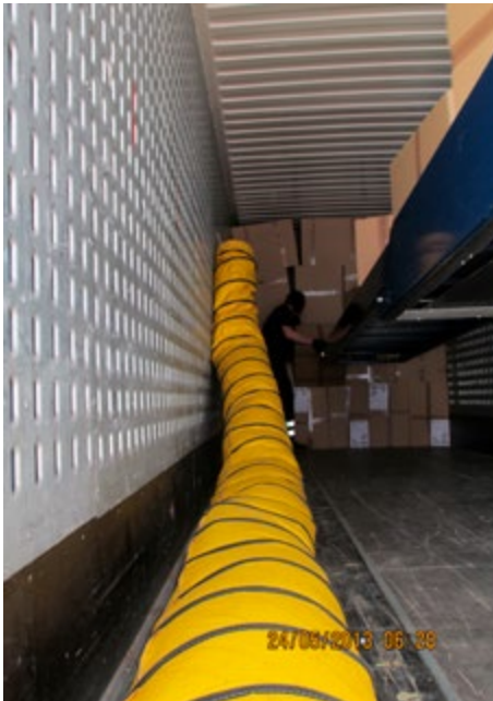
Abb. 9 und 10 Entladung einer Wechselbrücke unter Frischluftzufuhr mittels Luftleitung (Lutte)
