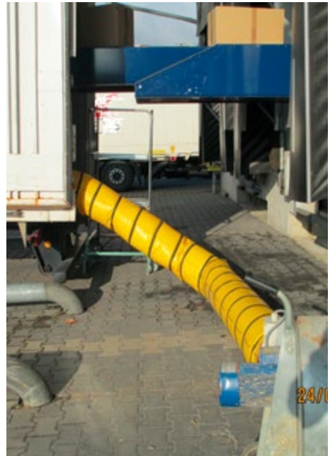
Abb. 9 und 10 Entladung einer Wechselbrücke unter Frischluftzufuhr mittels Luftleitung (Lutte)
