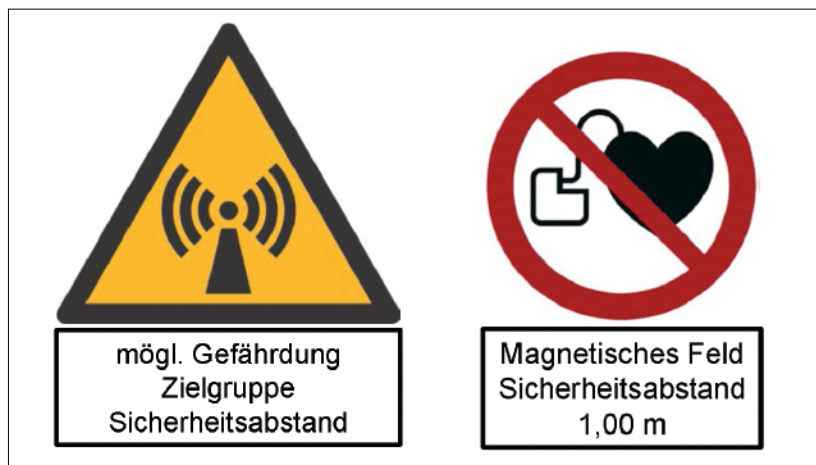
Abb. 4: Sicherheits- und Gesundheitsschutzkennzeichnung nach ASR A1.3 und Zusatzkennzeichnung, links: Warnung vor Nichtionisierender Strahlung (W005), rechts: Kein Zutritt für Personen mit Herzschrittmachern oder implantierten Defibrillatoren sowie sonstigen aktiven Implantaten (P007).
