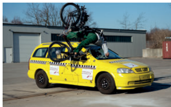
Abb. 13: Zusammenstoß zwischen stehendem Fahrzeug und in die Seite fahrenden S-Pedelec (v=44km/h)
