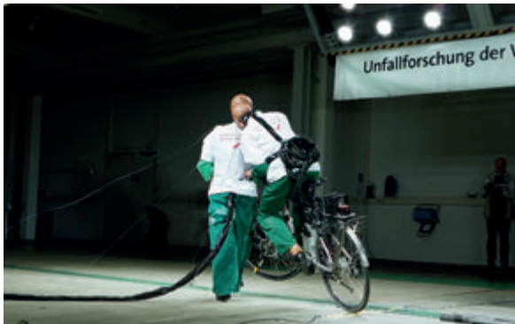
Abb. 14: Zusammenstoß zwischen S-Pedelec (v=25 km/h) und Fußgänger
