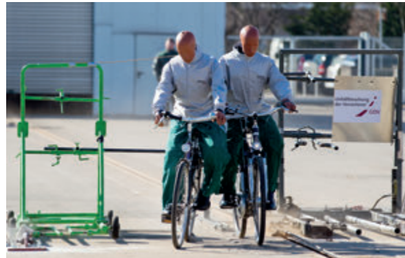
Abb. 12: Zusammenprall zwischen Fahrrad (v=22 km/h) und überholendem Pedelec (v=44 km/h)
