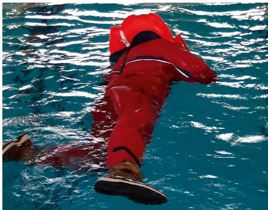
Unkontrollierte Lufteinschlüsse an Beinen und Rücken beeinträchtigen die ohnmachtsichere Lage bei Verwendung einer Rettungsweste mit 150 N Auftrieb
