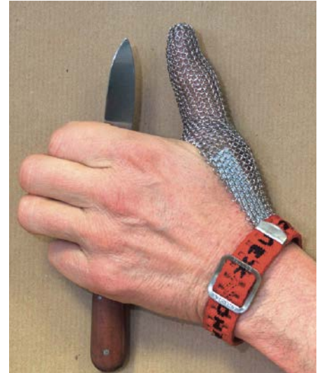
Abb. 4: Dieser „Spezialhandschuh“ bietet Schutz gegen Stich und Schnitt bei Arbeiten, bei denen das Messer zum Daumen geführt wird, z. B. Abisolieren (wofür es auch Spezialwerkzeug gibt!) oder auch Gemüse schneiden.
