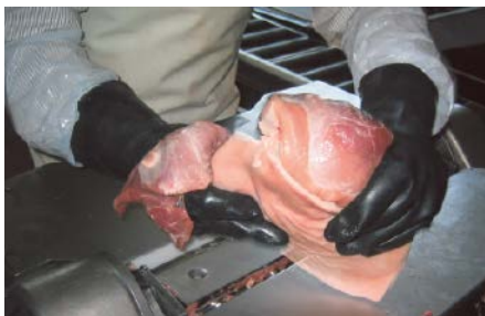
Abb. 3: Arbeiten an einer Entschwärtungsmaschine mit an den Fingerspitzen verstärkten Chemikalienschutzhandschuhen. Spezielle Handschuhe für diese Tätigkeit gibt es nicht. Das Schutzkonzept sieht vor, dass bei Messerkontakt und Erfassen des Handschuhes die Fingerspitzen des Handschuhes abgeschnitten werden und dem Benutzer so ein Entkommen ermöglichen.
