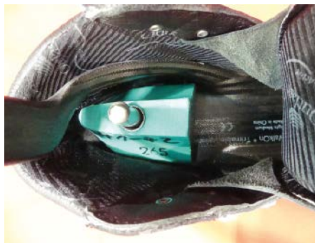
Abb. 2: Prüfung Energieaufnahmevermögen im Fersenbereich; Bildquelle: IFA
