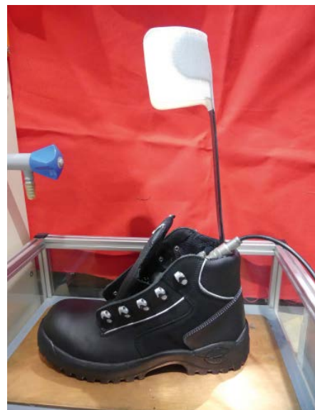
Abb. 1: Prüfung Antistatik; Bildquelle: IFA
