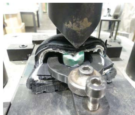
Abb. 3: Prüfung Resthöhe unter der Zehenkappe – Zerstörungsprüfung; Bildquelle: IFA
