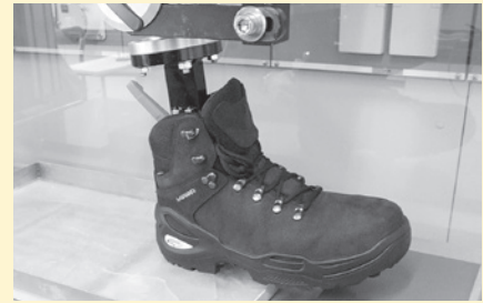
Abb. 3: Bestimmung des Gleitreibungskoeffizienten nach DIN EN ISO 13287, Verfahren A/C-Ferse-Vorwärtsgleiten
