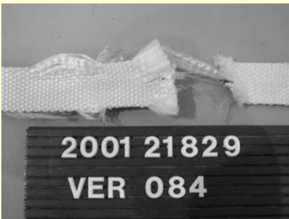
Abbildung 7: gerissenes Verbindungsmittel (Gurtband)
