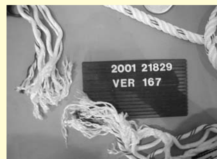
Abbildung 9: beschädigtes Verbindungsmittel (gedrehtes Chemiefaserseil)
