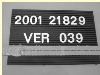
Abbildung 8: beschädigtes Verbindungsmittel (Gurtband)
