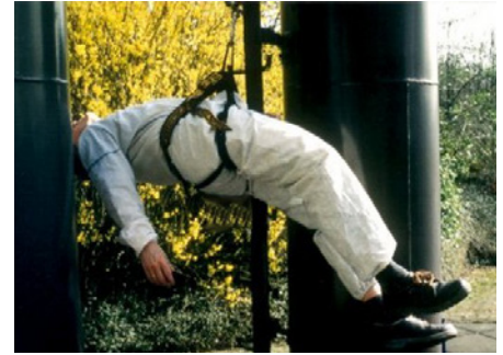
Abb. 5: ungünstige Hängeposition nach einem Auffangvorgang bei unzulässiger Verwendung von Sitzgurten (Quelle: Autor)
