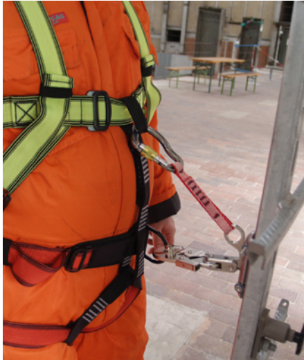
Abb. 4b: Beispiel für eine richtige Zuordnung von Auffanggurt und mitlaufendes Auffanggerät (Quelle: Fa. Bornack)
