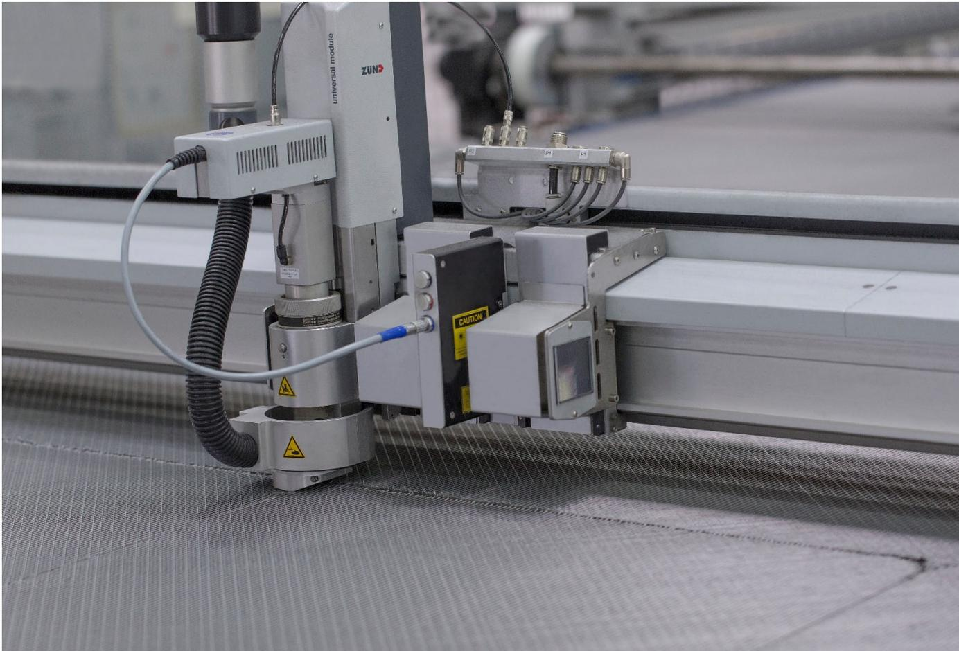
Beim mechanischen Zuschchnitt wird der entstehende CFK-Staub an der Entstehungsstelle abgesaugt.
