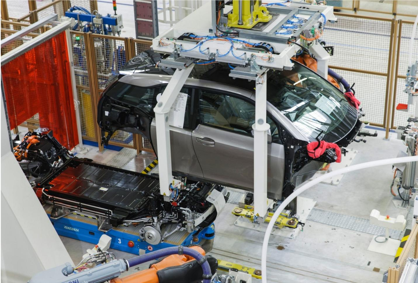
Bei der Hochzeit werden die CFK-Fahrgastzelle und das Aluminium-Chassis miteinander verklebt. Zusätzlich gibt es vier Verschraubungspunkte.
