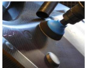
**Bild 1:** Schleifen von CFK Bauteilen
