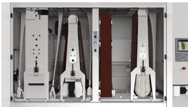
Bild 1: Moderne Breitbandschleifmaschine für mehrstufige Bearbeitung in gekapselter Ausführung
