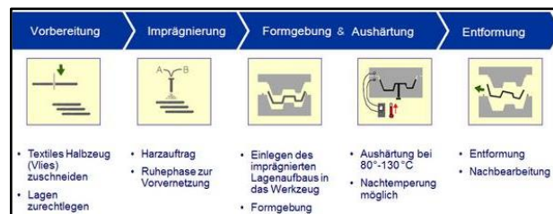
Bild 6: Spezielle Prozessschritte beim Nasspressen (siehe Seite 6)
