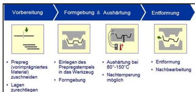
Bild 5: Spezielle Prozessschritte Prepreg Verfahren
