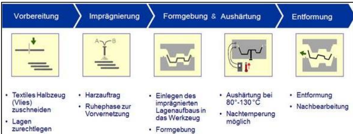
Bild 6: Spezielle Prozessschritte beim Nasspressen
