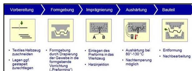
Bild 8: Spezielle Prozessschritte beim Resin Transfer Moulding (RTM) (siehe Seite 6)
