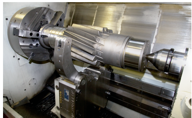
Abbildung 1 – Futter, nicht gespannte Lünette und Pinole auf Reitstock mit 600 kg Werkstück
