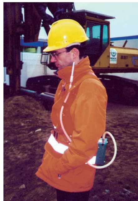
Abb. 2: Personenbezogene Messung, Probenahmegerät am Mann getragen
