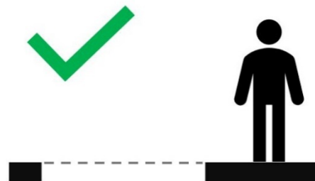
Abb. 2: Bauteil auf Höhe des Standplatzes
